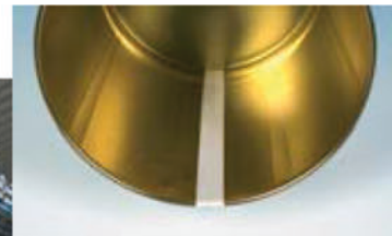
Sauber abgedeckt: Pulver beschichtete Naht im Weissblechgebilde.
