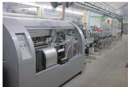
Die neue Linie: Im Vordergrund Schweissmaschine Can Man X8, daran anschliessend Trocknungseinheit Frei ECM zum Aushärten der Pulverbeschichtung, oben Staustrecke.
