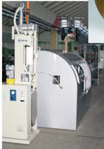
Die Pulvernahtabdeckeinheit MPC ist am Kopfende der Linie platziert.
